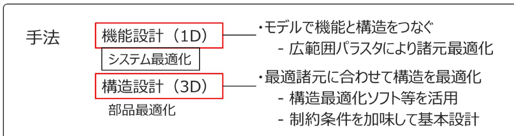
構造設計前に機能設計を導入し、MBD手法を応用して関連付けと諸元最適化
